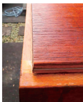
⑥サンドペーパーを使い、平面を平滑に仕上げていきます。
