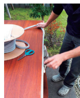
⑪四方にパッキンがまわったら、パッキンをめくりながら接着剤を塗布していきます。
