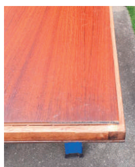
⑦新しいパッキンを取り付けていきます。 ※この時点では接着剤は使用しないでください。
