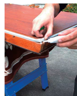
⑨四方にパッキンがまわったら、パッキンをめくりながら接着剤を塗布していきます。
