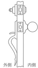
実際に開閉する扉に取り付けるハンドルとロックのセットです。内側の形状は丸ノブとレバーから選べます。施錠は外側から鍵で、内側からはターンピースで行います。
