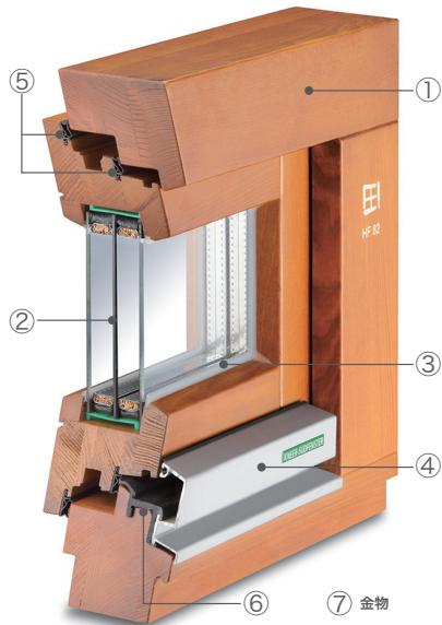
①枠類は目の詰んだ木材を高乾燥、その中から厳選された木材だけを使用し加工します。枠やガラス障子は、5層の集成構造。工場塗装はムラのない均一な塗装を施します。(ベース塗装を含めて4回塗装を施します)
