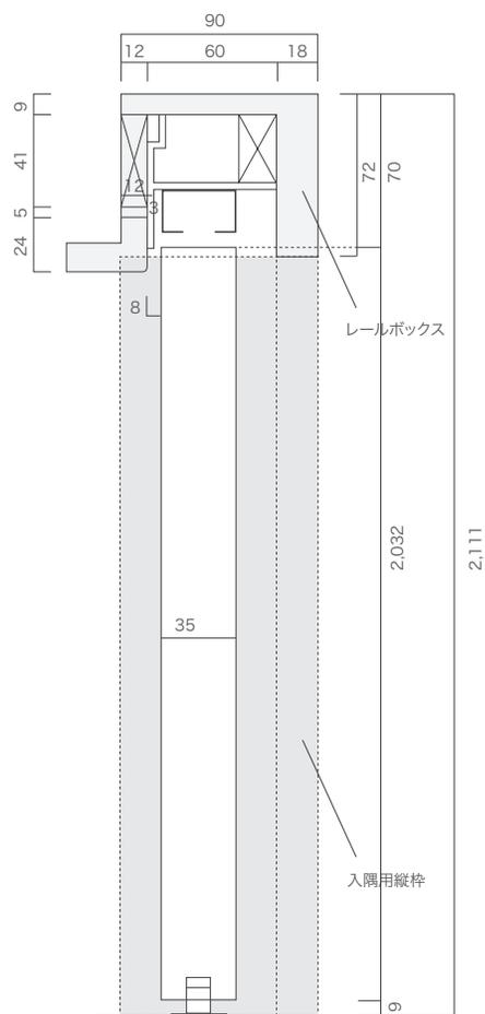
154mm固定枠ノックダウン 壁厚130mm用 納まり図
