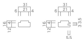
内部ドア標準納まり図(差込枠)
