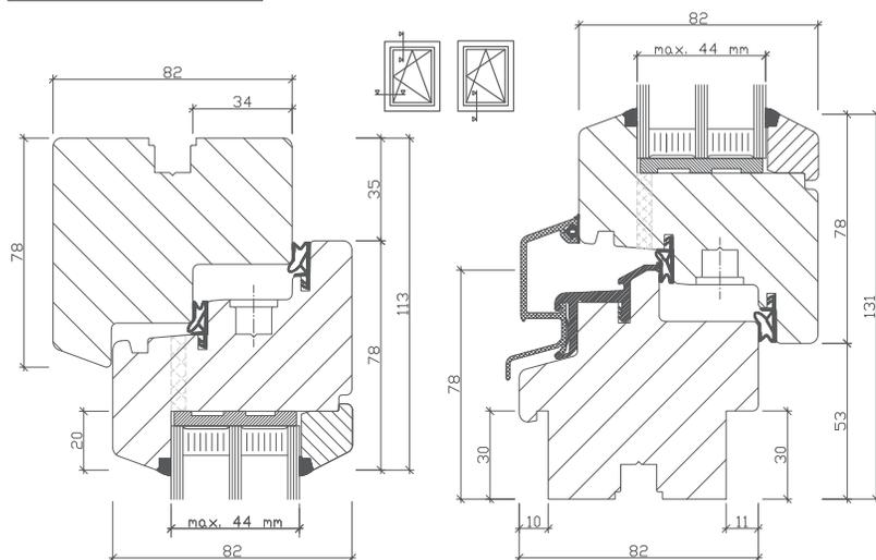
① 枠類は目の詰んだ木材を高乾燥、その中から厳選された木材だけを使用し加工します。枠やガラス障子は、5層の集成構造。工場塗装はムラのない均一な塗装を施します。(ベース塗装を含めて4回塗装を施します)
