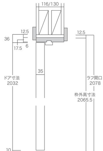
154mm 固定式ノックダウン 壁厚 130mm 用 納まり図
