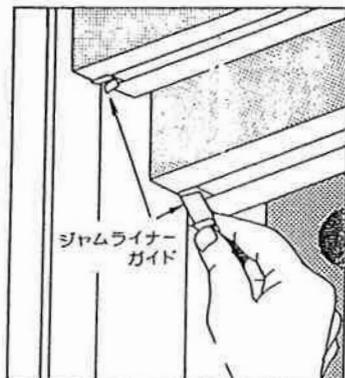
8 最初の手順通りサッシュを戻します。図のようにジャムライナーガイドをサッシュ両脇のウェザーストリップの溝に差し込みます。このガイドはジャムライナーのによるウェザーストリップの破損を防ぐのものです。
